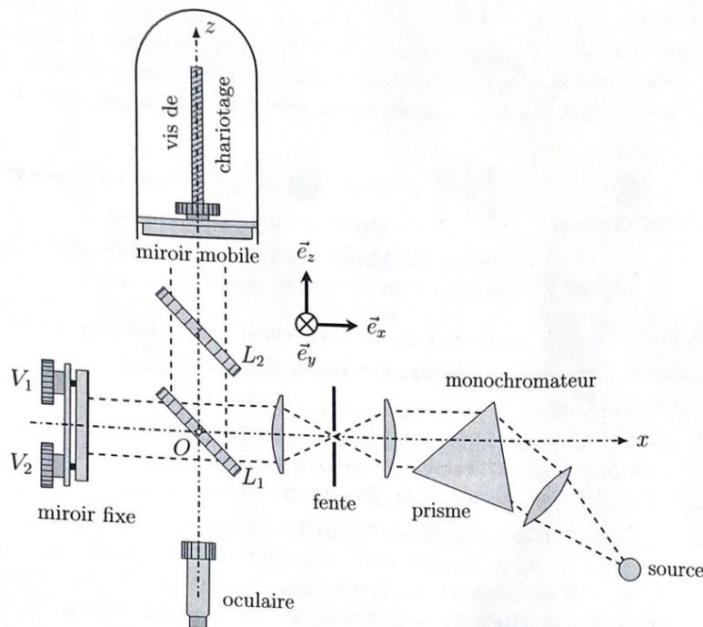
FIGURE 2 – Dispositif de mesure en spectroscopie interférentielle
